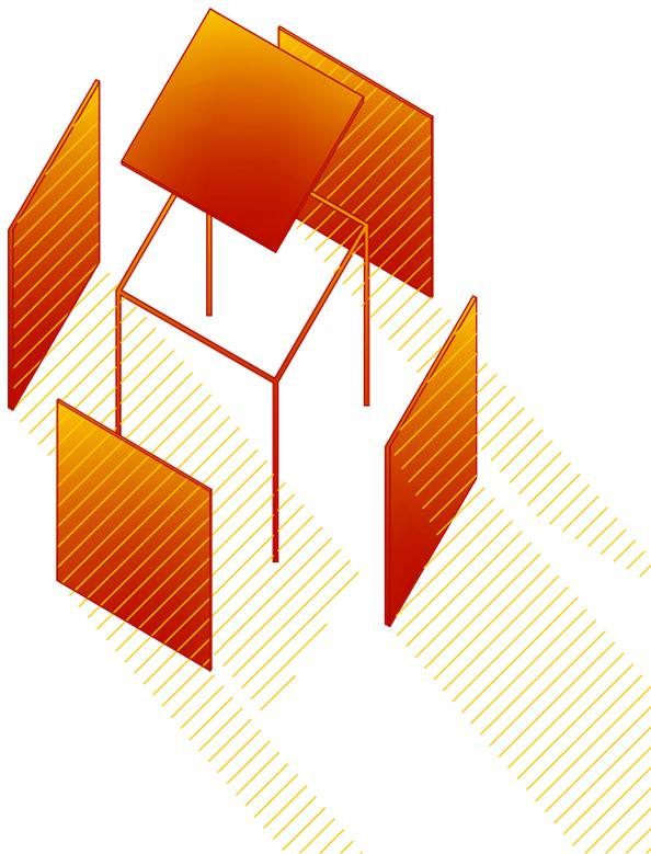
Il reticolo strutturale portante è costituito da **tubi innocenti per impalcature** e da tamponamenti diversi adeguati alle diverse funzioni.
