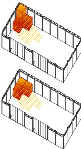
Le caratteristiche modulari della struttura permettono di sfruttare i volumi in due modi differenti: su uno o due livelli. La soluzione più semplice è quella su un piano, ma non è da escludere l'altra soluzione, poichè presenta vantaggi e svantaggi da considerare.
